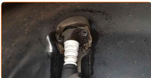
**26** Instalați șuruburile de fixare.
