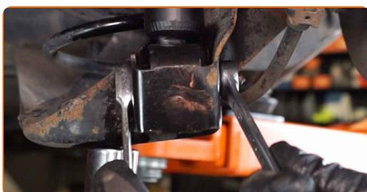
**30** Pentru a strânge corect elementele de fixare, trebuie să ridicați cu cricul componentele suspensiei în poziția lor de lucru. Folosiți un cric hidraulic pentru cutia de viteze.
