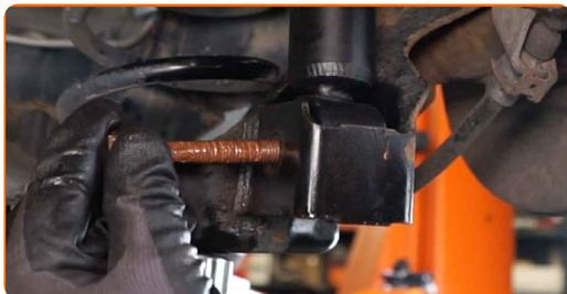
**29** Înșurubați elementul de fixare de jos al amortizorului. Utilizați o cheie în combinație fixă N°16 (2 bucăți). Folosiți o cheie cu clichet.
