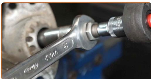
**19** Demontați suportul, burduful de protecție împotriva prafului și tamponul limitator ale amortizorului.
