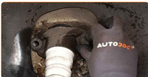
**27** Înșurubați elementele de fixare ale suportului amortizorului. Utilizați o cheie tubulară №16. Folosiți o cheie cu clichet.
