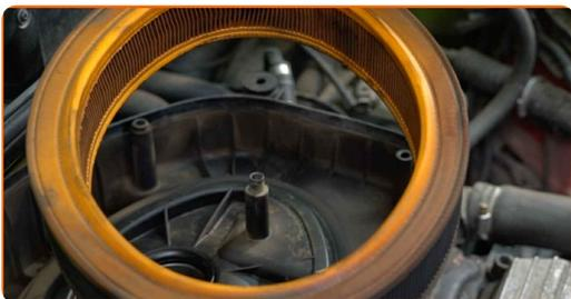
**7** Acoperiți furtunul de admisie a aerului cu o lavetă din microfibră, pentru a preveni pătrunderea prafului și murdăriei în interiorul sistemului.
