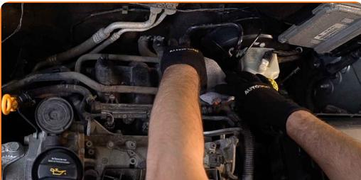
5 Desfaceți elementele de fixare din plastic ale conectorului bobinei de inducție. Folosiți o șurubelnită dreaptă.
