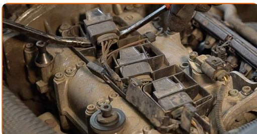
7 Scoateți bobina de inducție din spațiul pentru bujii.
