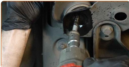
**10** Deșurubați elementul de fixare ce conectează rotula suspensie la brațul de control al suspensiei. Utilizați o cheie tubulară №16. Folosiți un port tarod.
