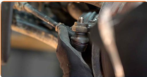
**15** Înșurubați piulița de blocare a capului barei de direcție transversale. Utilizați o cheie în combinație fixă №19. Utilizați o cheie în combinație fixă №22.
