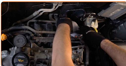
5 Desfaceți elementele de fixare din plastic ale conectorului bobinei de inducție. Folosiți o șurubelnită dreaptă.
