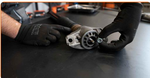
**17** Înșurubați elementul de fixare superior al tijei amortizorului. Utilizați o cheie în combinație fixă №16. Folosiți o cheie reglabilă. Folosiți o cheie de cuplu. Strângeți pînă la cuplul de 25 Nm.
