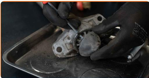
**13** Îndepărtați elementul de fixare al tijei pistonului amortizorului. Utilizați o cheie în combinație fixă №16. Folosiți o cheie reglabilă.
