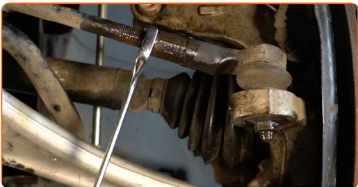
**9** Deșurubați piulița de fixare a capătului la fuzetă. Utilizați o cheie tubulară №18. Folosiți un port tarod.
