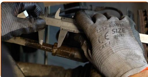
**8** Slăbiți contrapiulița de cuplare a capului barei de direcție pe tijă. Utilizați o cheie în combinație fixă №24.
