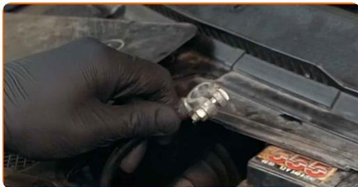
**21** Slăbiți elementele de fixare ale alternatorului. Folosiți cheia hexagonală nr. H8.
