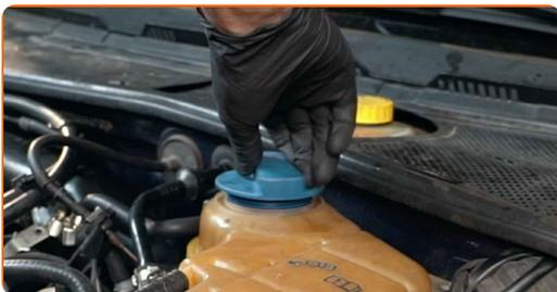
**54** Înșurubați capacul rezervorului cu lichid de răcire.
