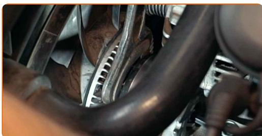
**23** Slăbiți elementele de fixare ale alternatorului. Folosiți cheia hexagonală nr. H8.
