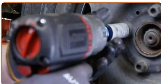
**49** Așezați din nou vehiculul la sol și, lucrând în ordine încrucișată, strângeți șuruburile de fixare ale roții. Folosiți o cheie tubulară de impact pentru roată #17. Folosiți o cheie de cuplu. Strângeți pînă la cuplul de 110 Nm.
