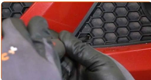
**2** Utilizați banda adezivă de mascare pentru a împiedica deteriorarea pieselor din plastic și vopsite ale automobilului.
