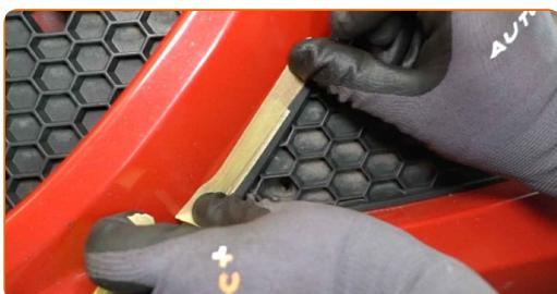
**3** Demontați grila farului de ceată. Folosiți un instrument de demontat tapiterii.
