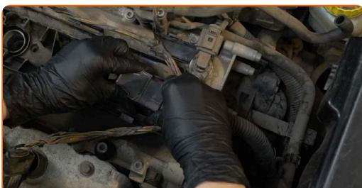
**10** Instalați bobinele de aprindere în puțurile bujiilor. Asigurați-vă că s-a produs un clic, care semnifică instalarea corectă în canelurile de fixare.
