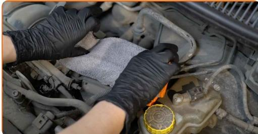
**6** Scoateți bobina de inductie din spațiul pentru bujii Folosiți o rangă.
