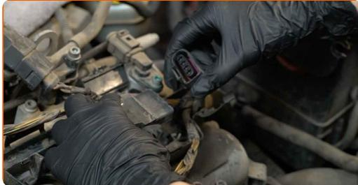
**8** Tratați contactul bobinei de aprindere cu spray pentru instalații electrice. Spray-ul va proteja contactele electrice împotriva coroziunii, oxidării și va reduce rezistența la contact.
