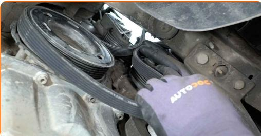
**8** Scoateți deoparte rolă de tensionare a curelei de transmisie Poli-V. Utilizați o cheie în combinație fixă №16.
