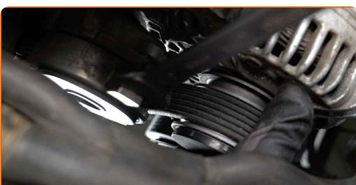
**10** Aduceți rolă de tensionare în poziția sa inițială.
