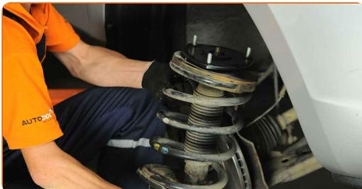
**20** Montați bara de sprijin amortizor pe dispozitivul special pentru comprimarea arcurilor.
