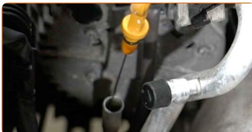
**4** Deșurubați bușonul de umplere cu ulei.
