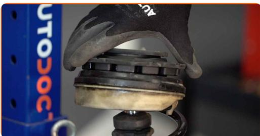
**33** Strângeți șurubul tijei pistonului barei de sprijin amortizor. Folosiți cheia hexagonală nr. H6. Utilizați o cheie în combinație fixă №18. Folosiți o cheie de cuplu. Strângeți pînă la cuplul de 62 Nm.
