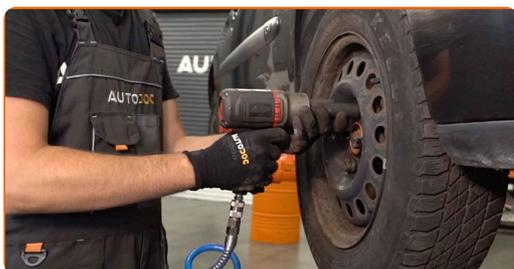
**32** Așezați din nou vehiculul la sol și, lucrând în ordine încrucișată, strângeți șuruburile de fixare ale roții. Folosiți o cheie de cuplu. Strângeți pînă la cuplul de 90 Nm.
