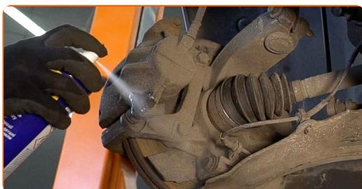
**8** Deșurubați fixarea etrierului de frână. Utilizați o cheie tubulară №13. Folosiți o cheie cu clichet.
