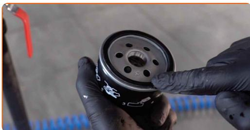
**14** Înșurubați noul filtru în poziția de lucru. Folosiți o cheie tubulară pentru filtrul de ulei de 76/14-F. Folosiți o cheie de cuplu. Strângeți pînă la cuplul de 21 Nm.
