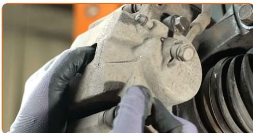
**19** Instalați șuruburile de fixare.
