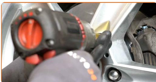
26 Așezați din nou vehiculul la sol și, lucrând în ordine încrucișată, strângeți șuruburile de fixare ale roții. Folosiți o cheie tubulară de impact pentru roată #19. Folosiți o cheie de cuplu. Strângeți pînă la cuplul de 103 Nm.
