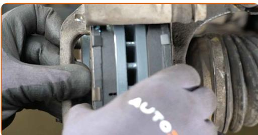
**16** Tratați pistoanele etrierelor de frână. Utilizați o perie curățitoare din nylon. Folosiți un spray curățare frâne.
