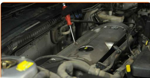
**4** Îndepărtați capacul motorului. Folosiți o șurubelniță dreaptă.
