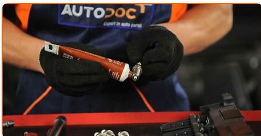
**12** Instalați noile bujii în locurile lor de montare. Folosiți o cheie tubulară pentru bujii #16.
