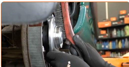
**13** Tratați suprafața de contact. Utilizați lubrifiant ceramic.
