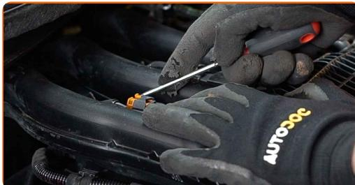
4 Deconectați suportul de fixare al bobinei de inducție. Utilizați o cheie tubulară №8.
