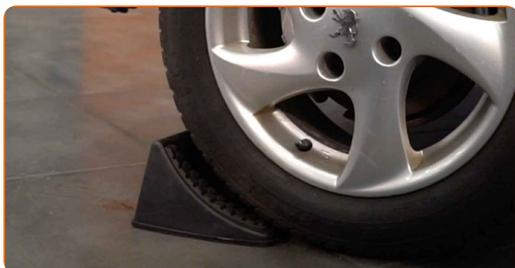
**2** Slăbiți șuruburile de fixare a roții. Folosiți o cheie tubulară de impact pentru roată #19.
