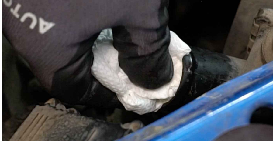
19 Curățați carcasa termostatului. Folosiți o perie de sârmă. Folosiți spray de curățare universal.
