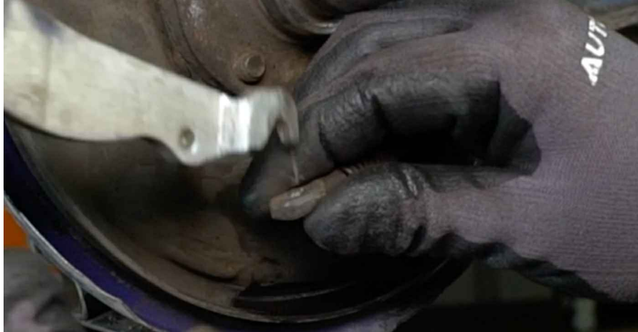
21 Demontați sabotul frânei din stânga.
