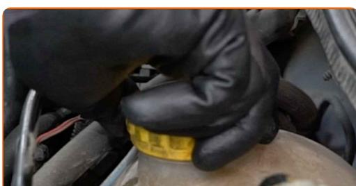
**38** Lăsați motorul să funcționeze timp de câteva minute. Acest lucru trebuie efectuat pentru a elimina aerul rezidual din sistemul de răcire și pentru a verifica dacă componentele funcționează corect.
