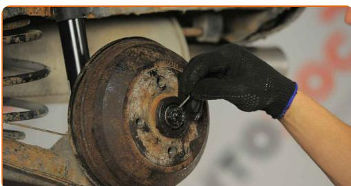
**25** Instalați capacul de protecție al rulmentului butucului. Folosiți un ciocan de cauciuc.
