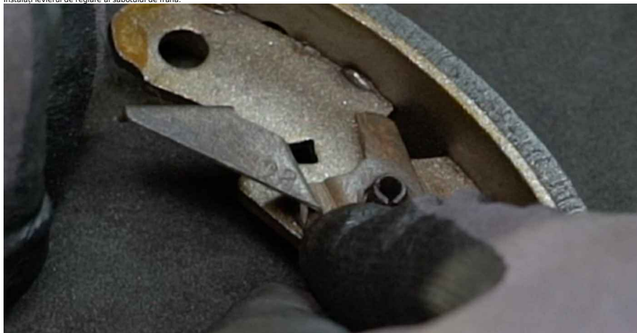
34 Instalați inelul de siguranță.
