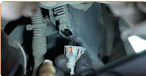
**6** Deșurubați dispozitivul de fixare al senzorului de oxigen. Utilizați o cheie inelară semideschisă Nr. 22.
