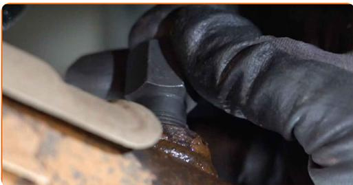
**9** Tratați senzorul de oxigen. Utilizați lubrifiant ceramic rezistent la temperaturile înalte.
