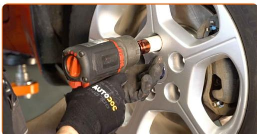
23 Așezați din nou vehiculul la sol și, lucrând în ordine încrucișată, strângeți șuruburile de fixare ale roții. Folosiți o cheie de cuplu. Strângeți pînă la cuplul de 108 Nm.
