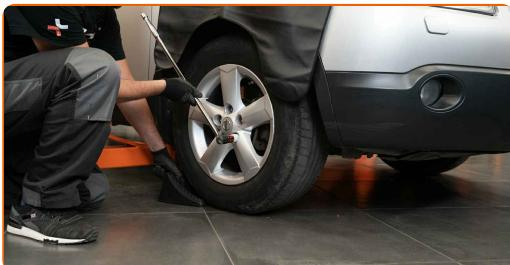
**4** Slăbiți șuruburile de fixare a roții. Folosiți o cheie tubulară de impact #21.
