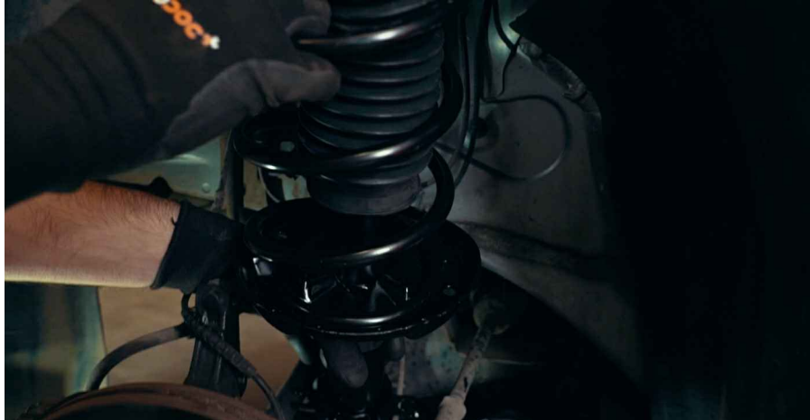
16 Strângeți elementele de fixare la cuplul de strângere recomandat de către constructorul de automobile
