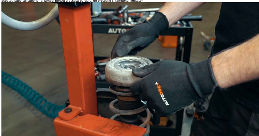
Rețineți! • Tamponul limitator poate fi instalat pe tija pistonului sau fixat de suport • Burduful de protecție poate fi montat pe tamponul limitator, instalat între arc și suport sau fixat pe suport.
