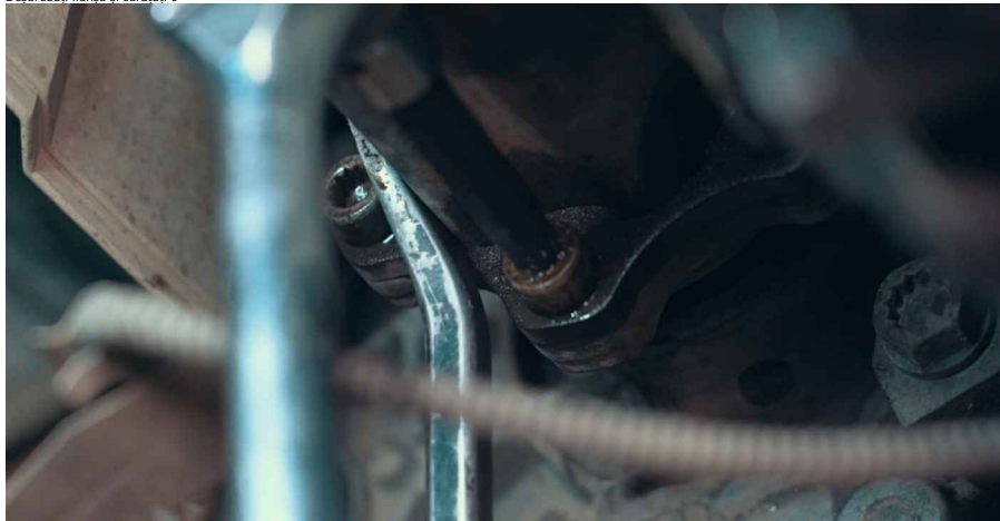
11 Instalați un ax planetar nou
