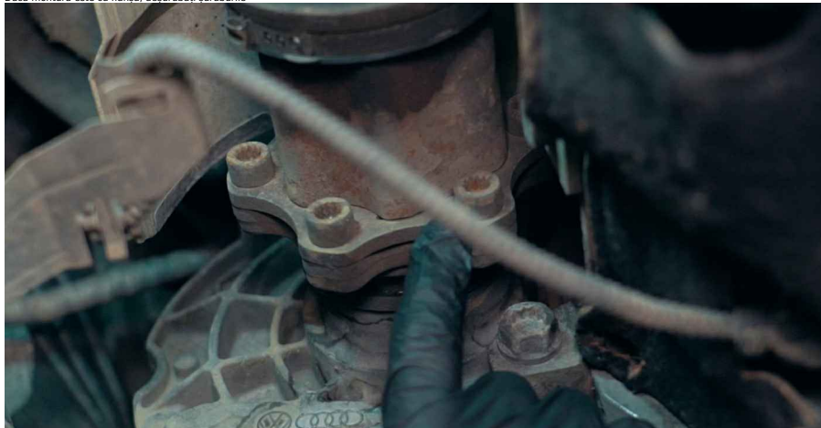
Experti AUTODOC recomandă: • Fixați axul planetar pentru a împiedica rotirea acestuia
