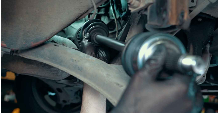
8 Dacă montura este cu flanșă, desurubați suruburile
