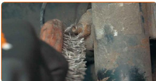
**14** Deșurubați elementul de fixare ce unește bieleta antirului de telescopul amortizorului. Utilizați o cheie tubulară №17. Folosiți o cheie cu clichet.
