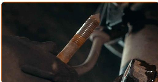
**21** Deșurubați elementul de fixare ce conectează arborele de transmisie la butucul roții. Utilizați o cheie tubulară №32. Folosiți o cheie cu clichet.
