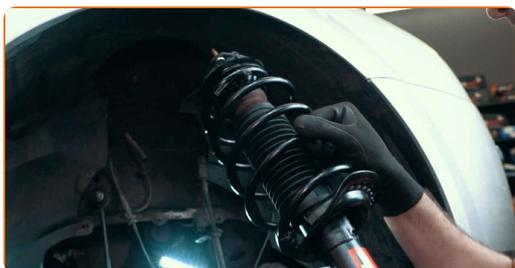
**45** Securizați elementele de fixare superioare ale telescopului amortizorului (3 bucăți). Nu îl strângeți.
