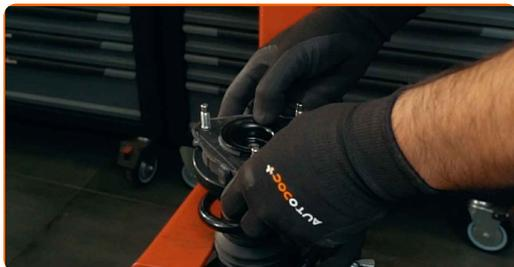
**39** Strângeți șurubul tijei pistonului barei de sprijin amortizor. Utilizați o cheie tubulară №19. Folosiți cheia hexagonală nr. H6. Folosiți o cheie de cuplu. Strângeți pînă la cuplul de 55 Nm.
