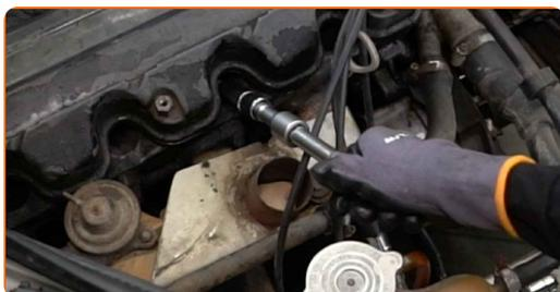
**13** Înșurubați noile bujii și strângeți-le. Folosiți o cheie tubulară pentru bujii #16. Folosiți o cheie de cuplu. Strângeți pînă la cuplul de 22 Nm.
