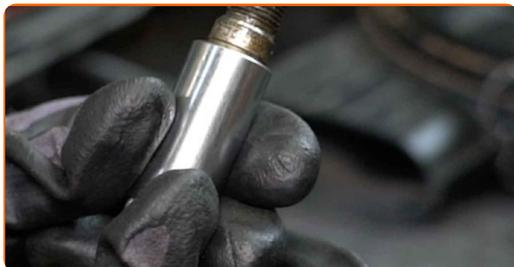
**11** Aplicați un strat subțire de pastă specială anti-gripantă rezistentă la temperaturi înalte pe filetul noilor bujii.
