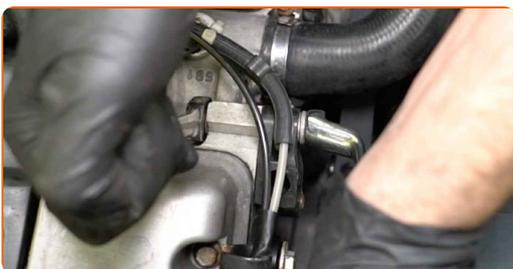
**4** Utilizați o pârghie cu diametrul corect pentru a slăbi dispozitivul de tensionare și scoateți șurubul de fixare. Utilizați o piesă de prelungire cu cap pătrat 3/8" pentru cheie tubulară.
