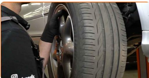
7 Deconectați fișa senzorului de uzură a plăcuțelor de frână. Folosiți clești cu vârful rotund.
