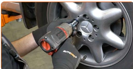
**34** Așezați din nou vehiculul la sol și, lucrând în ordine încrucișată, strângeți șuruburile de fixare ale roții. Folosiți o cheie tubulară de impact pentru roată #17. Folosiți o cheie de cuplu. Strângeți pînă la cuplul de 110 Nm.
