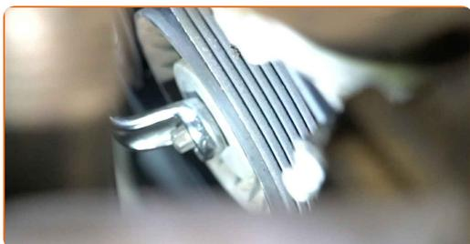
**11** Aduceți rola de tensionare în poziția sa inițială. Utilizați o cheie în combinație fixă №16.
