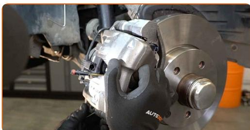
**34** Conectați fișa senzorului de uzură a plăcuțelor de frână.
