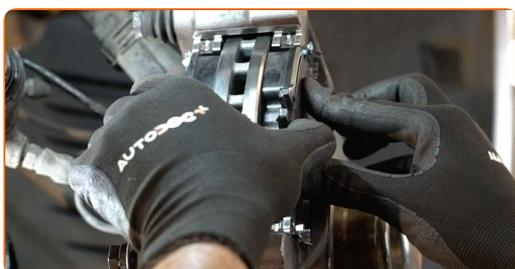
**31** Conectați senzorul de uzură al plăcuțelor de frână.
