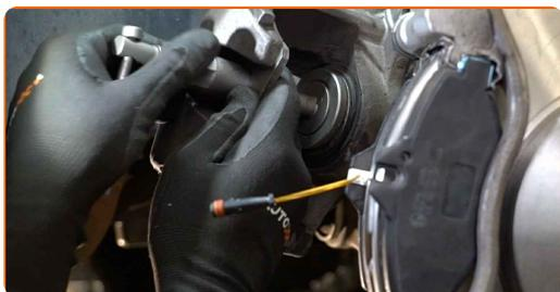
**33** Montați etrierul de frână și fixați-l. Utilizați o cheie în combinație fixă №17. Utilizați o cheie tubulară №13. Folosiți o cheie de cuplu. Strângeți pînă la cuplul de 35 Nm.
