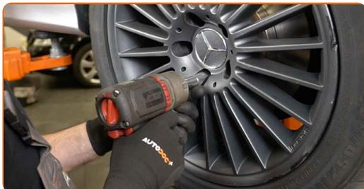
**39** Așezați din nou vehiculul la sol și, lucrând în ordine încrucișată, strângeți șuruburile de fixare ale roții. Folosiți o cheie tubulară de impact pentru roată #17. Folosiți o cheie de cuplu. Strângeți pînă la cuplul de 130 Nm.
