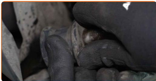
**14** Deșurubați elementul de fixare care unește articulație sferică la fuzetă. Utilizați o cheie în combinație fixă №18. Utilizați o cheie tubulară №19. Folosiți o cheie cu clichet.
