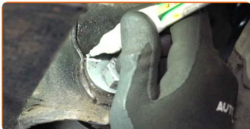
**10** Deșurubați dispozitivul de fixare din spate al pârghei de comandă. Utilizați o cheie în combinație fixă №22. Utilizați o cheie tubulară №22. Folosiți o cheie cu clichet.
