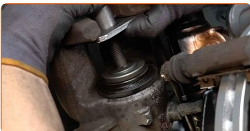
**19** Montați etrierul de frână și fixați-l.
