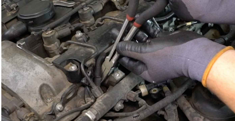
14 Tratați bujiile incandescente. Utilizați lubrifianți ceramici rezistenți la temperaturi înalte.
