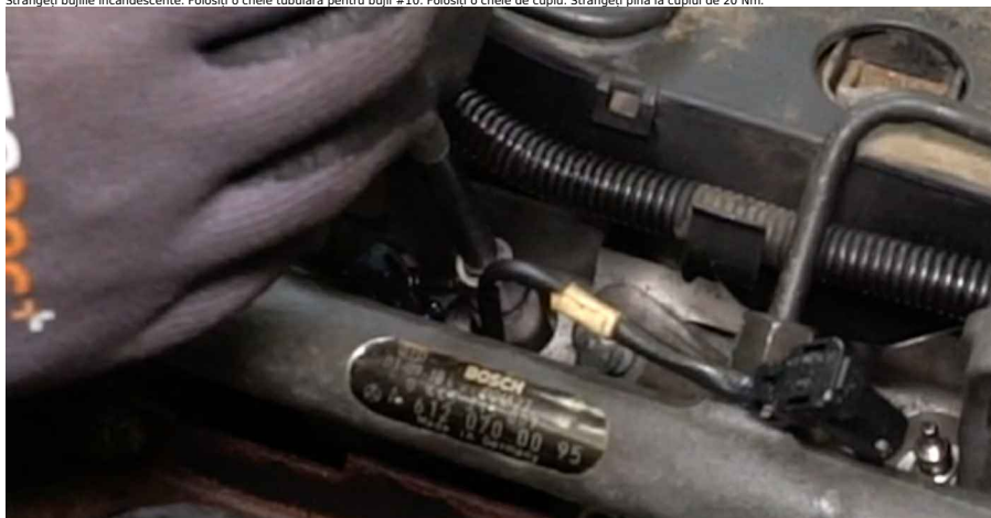
16 Strângeți bujiile incandescente. Folosiți o cheie tubulară pentru bujii #10. Folosiți o cheie de cuplu. Strângeți până la cuplul de 20 Nm.
