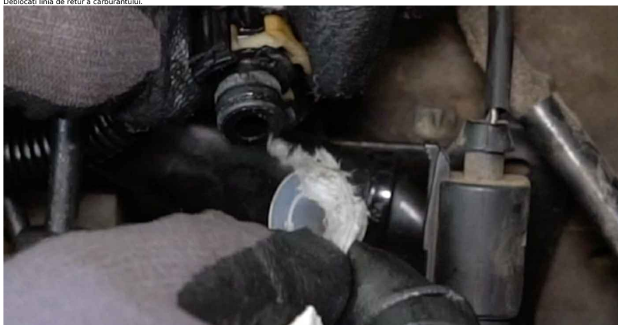
21 Conectați furtunul liniei de retur a carburantului.
