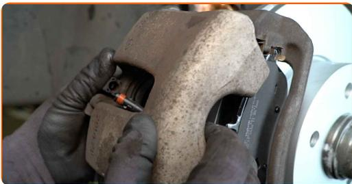
**21** Instalați șuruburile de fixare.
