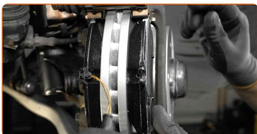
**20** Montați etrierul de frână și fixați-l.
