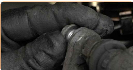
**22** Strângeți elementele de fixare ale etrierului de frână. Utilizați o cheie în combinație fixă №17. Utilizați o cheie tubulară №13. Folosiți o cheie de cuplu. Strângeți pînă la cuplul de 34 Nm.
