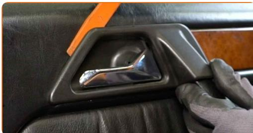
5 Deşurubați elementul de fixare al panoului portierei. Utilizați o cheie tubulară №10. Folosiți o cheie cu clichet.
