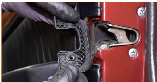
**4** Desprindeți panoul de decor al mânerului portierei. Folosiți un instrument de demontat tapițeriei.
