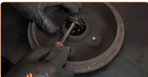
**12** Demontați manșonul interior al rulmentului roții din tamburul de frână. Folosiți un punctator. Folosiți un ciocan.
