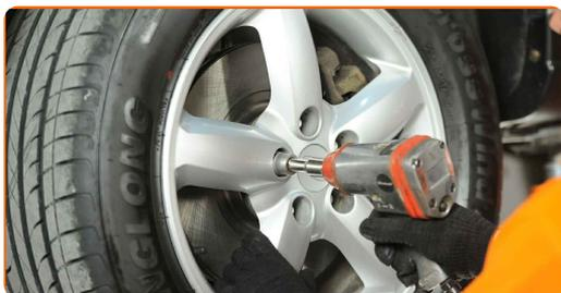
**26** Așezați din nou vehiculul la sol și, lucrând în ordine încrucișată, strângeți șuruburile de fixare ale roții. Folosiți o cheie tubulară de impact pentru roată #21. Folosiți o cheie de cuplu. Strângeți pînă la cuplul de 108 Nm.
