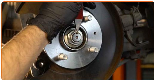
**26** Instalați capacul de protecție al rulmentului butucului. Folosiți un ciocan de cauciuc. Folosiți o rangă.
