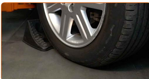
**3** Slăbiți șuruburile de fixare a roții. Folosiți o cheie tubulară de impact pentru roată #19.
