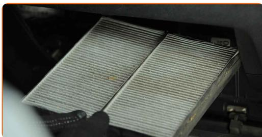
6 Îndepărtați din carcasa filtrului elementul de filtrare care urmează să fie înlocuit.
