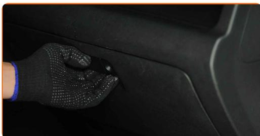
**3** Demontați limitatorul de deschidere. Folosiți o șurubelniță dreaptă.
