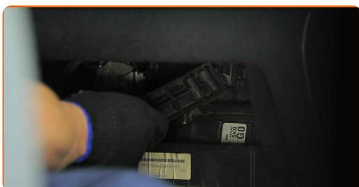
**11** Montați limitatorul de deschidere al torpedoului.
